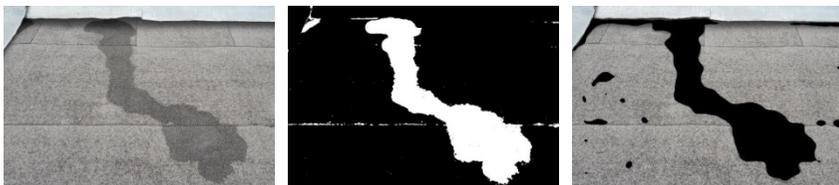
**Рис. 4.** Примеры распознавания дефектов (.../Def\_9) с использованием глубокой полностью свёрточной нейронной сети: слева – исходное изображение; в центре – подготовленная бинарная маска; справа – оцененный по параметрам дефект
